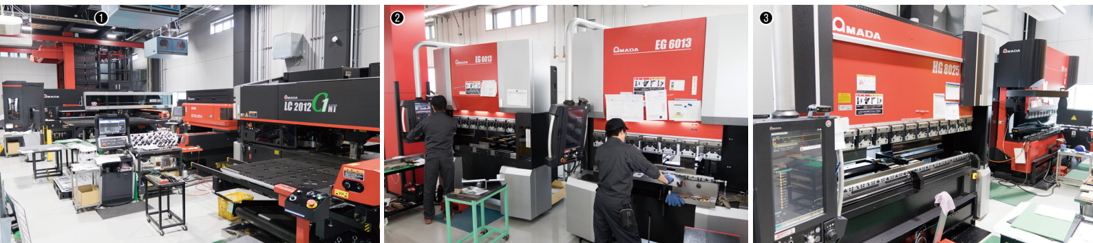
①パンチ・レーザ複合マシンACIES-2512T+ASR-2512NTK(奥)、LC-2012C1NT(手前)、レーザマシンLC-1212αIVNTが並ぶ／②高速・高精度な小物曲げ加工に対応するベンディングマシンEG-6013／③ベンディングマシンHG-8025(手前)と追従装置付きのHDS-1303NT(奥)
