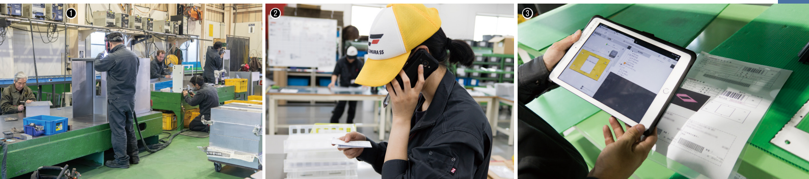
①第2工場の溶接・組立工程／②すべてのスタッフにモバイル端末を配布し、進捗情報の入力やコミュニケーションに役立てている／③作業指示書(右)のバーコードを読み込み、タブレット端末(左)で「Web受発注サービス」のパーツ情報を表示する
